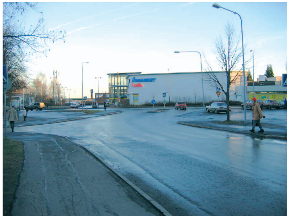
Kuva 10. Keskustien, Beckerintien ja Otto Mannisen tien liittymä. Liittymä alue on laaja, siinä risteävät läpikulkuliikenne, jalankulkijat ja pysäköintipaikoilta tuleva liikenne. Jalankulkijoiden ylitys olisi turvattava liittymää muotoilemalla.
